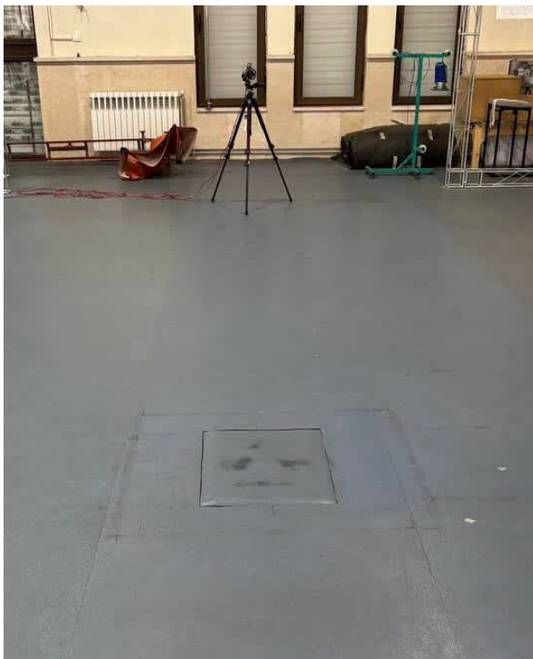
شکل ۱. چیدمان صفحه نیرو و دوربین مادون قرمز برای ثبت سرعت حرکت.
