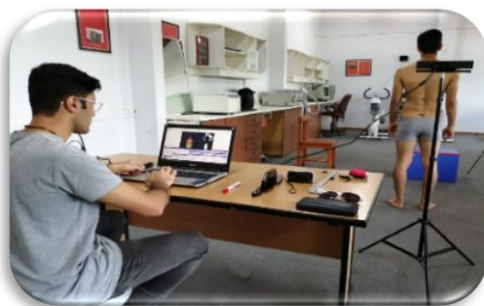
تصویر ۲: نحوه اندازه‌گیری راستای ستون فقرات با استفاده از دوربین کینکت مایکروسافت
