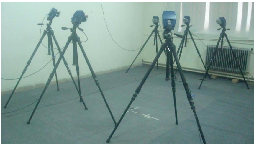
تصویر ۲: وضعیت قرارگیری ۶ دوربین اپتوالکترونیک
